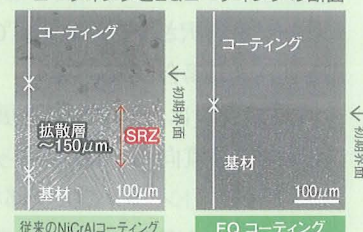
●1100℃、300時間加熱後の従来型コーティングとEQコーティングの断面
