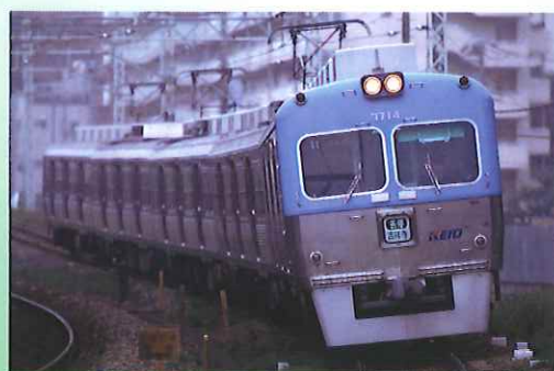
日本で初めて車両前面にFRPを採用した京王3000系電車 (資料提供: 京王電鉄(株))
