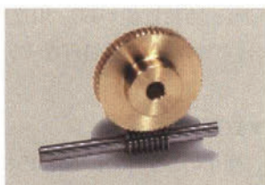
ウォームホイールにアルミ青銅 (CAC702)、ウォームにはクロムモリブデン鋼 (SCM440) が使用されたウォームギヤ。歯面の焼き付き、かじりを防ぐため、ウォームギヤでは異なる材料を組み合わせるのが一般的。
