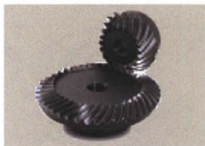
浸炭焼入れ、研削仕上げのクロムモリブデン鋼 (SCM415) 製まがりばか歯車。SCM415、SCM420 等の強度向上には、全面浸炭焼入れを施す場合が多い。
