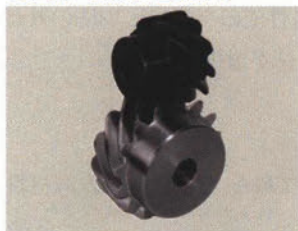
ねじ歯車はウォームギヤ同様、歯面の滑り摩擦が大きいため、異なる材料の歯車を組み合わせることが多い。黒は機械構造用炭素鋼 (S45C) 製、銀はステンレス鋼 (SUS303) 製。
