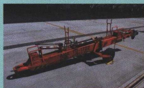
航空機体と牽引車をつなぐトーバー。例えばボーイング747を牽引する場合、500kgのトーバーを50tの車両につなげる。
