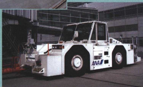
トータトラクターの例。車両仕様は重量3.5~50t、全長8.24m、全幅2.80m、馬力308ps(WT500E)、総排気量は10,000cc以上に及ぶ。
