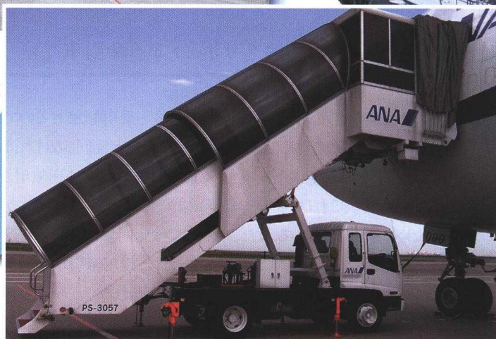
パッセンジャーステップ車が機体に装着されたようす。空港用支援車両では、乗客やオペレーター、メンテナンスからの様々な意見に基づいて、より快適で使いやすい機種が開発が進められている。(写真提供：全日本空輸(株))
