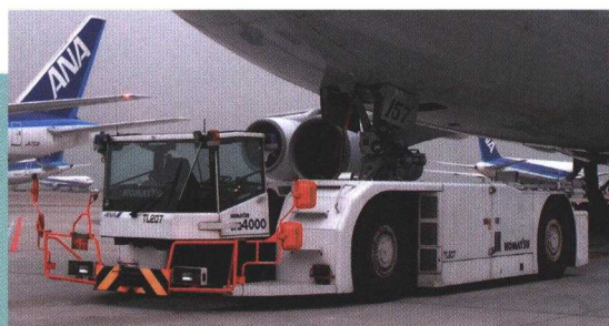
トータトラクターの例。トータトラクターでは安全を確保するため、航空機運転席にブレーキマンが乗るが、トータトラクターは一体化しているので航空機が無人でも問題はない。航空機を牽引するトータトラクター(右)。
