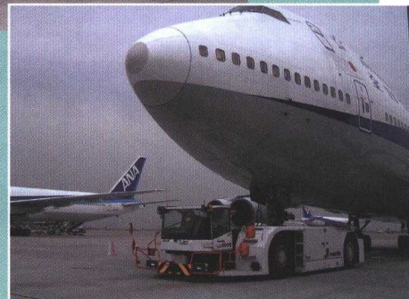
トータトラクターの例。トータトラクターでは安全を確保するため、航空機運転席にブレーキマンが乗るが、トータトラクターは一体化しているので航空機が無人でも問題はない。航空機を牽引するトータトラクター(右)。
