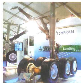
航空機降着装置等に体心立方系チタン合金が使用されはじめています。 Farnborough International Airshow 2010 展示品(写真提供:(株)神戸製鋼所)
