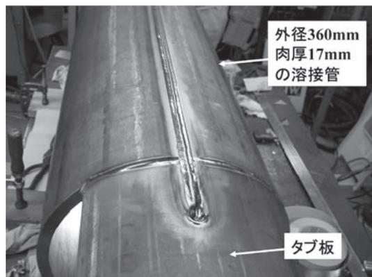
図3 曲げ+キーホールプラズママーク溶接により造管したTi-5Al-2Fe-1.5Mo製厚肉大径管の外観
