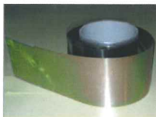
フレキシブルディスプレイの基板への応用が期待される絶縁膜付きステンレス箔。ステンレス箔に有機無機ハイブリッド酸化皮膜を生成し、新たな表面機能を発揮する。
