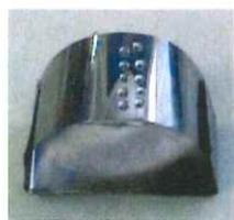
新しい応力腐食割れ試験法の試料例。曲げたステンレス板の上に液滴が付着している。
