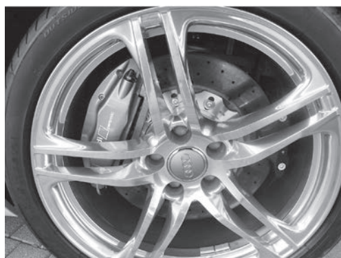
図2 炭素繊維強化SiCマトリックス複合材料を用いた自動車用ブレーキディスク。民生用自動車の軽量ブレーキディスクとして用いられている。炭素繊維は連続ではなく数mmの短いものを分散させている
