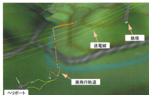
【図9-2】自律制御小型無人ヘリコプタによる送電線点検
