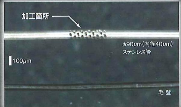
直径90μmのステンレス管に直径20μmの孔を貫通させることができるレーザー電解複合加工は、極細管の複雑形状を実現する加工法として、普及が期待されている。(写真提供: (独)産業技術総合研究所)
