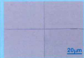
(b) ステルスダイシング (レーザーダイシング)
