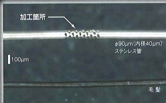
直径90μmのステンレス管に直径20μmの孔を貫通させることができるレーザー電解複合加工は、極細管の複雑形状を実現する加工法として、普及が期待されている。(写真提供: (独)産業技術総合研究所)
