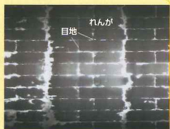
新たに考案した撮像方法での鮮明な炉壁画像
