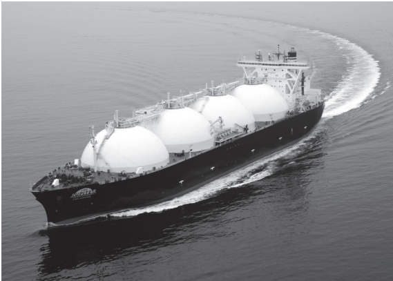
図8 モス型の液化天然ガス運搬船の一例 29)
