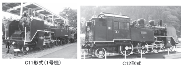
図3 蒸気機関車への最初の溶接適用(缶胴継手および車体、1930年～)
