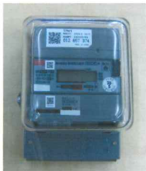
導入試験で使用されている次世代型電力メーターの例 現在は30分毎の電力使用量の遠隔検針、遠隔開閉操作機能などが搭載されている。
