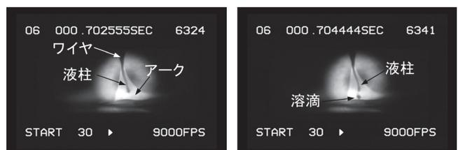
図8 Ar-MIG溶接の溶滴移行 (溶接電流300A、1.2mm鋼用ワイヤ)
