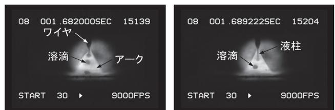
図7 MIG溶接の溶滴移行 (溶接電流300A、1.2mm鋼用ワイヤ)
