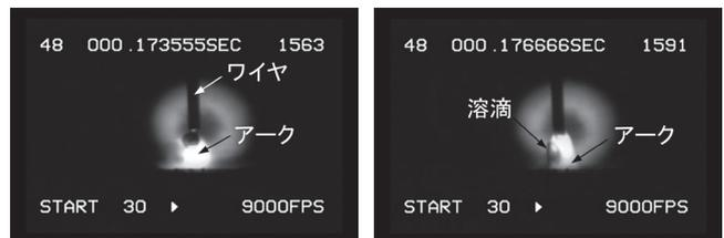
図6 MAG溶接の溶滴移行 (溶接電流300A、1.2mm鋼用ワイヤ)
