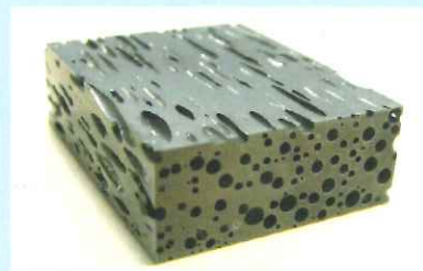
マグネシウムより軽量で 加工性、耐食性に優れた ロータスアルミニウム
