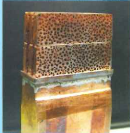
空冷型ヒートシンクに組み込んだロータス銅
