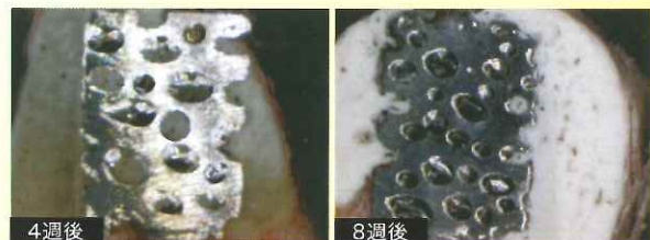
4週後 (左)では新生骨が気孔の一部に成長し、8週後(右)では気孔内に新生骨が侵入し固着している。
