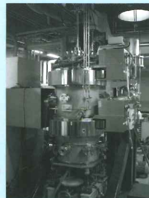
鋳型鋳造法の作製装置。この装置では、10kg程度のロータス金属を作製することが可能である。
