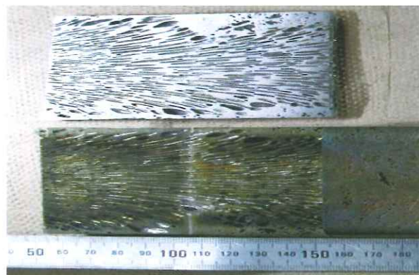
実用連続鋳造装置で作製したロータス炭素鋼 (窒素ガス圧2.5MPa, 引き抜き速度5.20mm/min)
