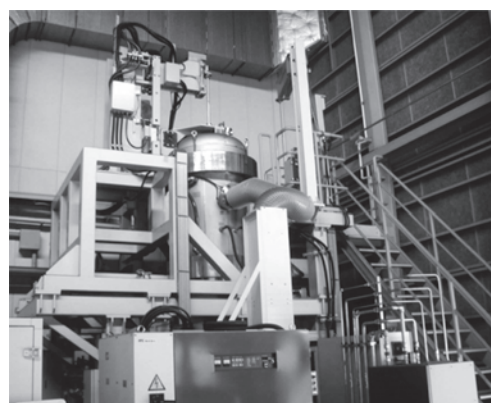
図1 ロータス炭素鋼作製用連続鑄造装置
