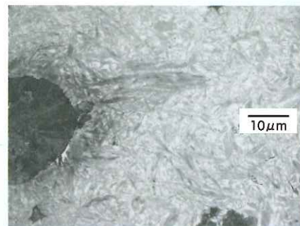
硬さ800Hvを示した部分の顕微鏡組織 きわめて微細な針状のマルテンサイト組織が生成している
