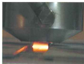
鉄鋼材料のFSWの様子 写真提供:大阪大学・藤井英俊教授
