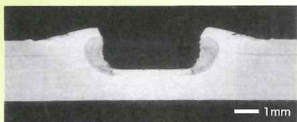
DP590のFSSW接合部断面 欠陥のない接合部が得られている
