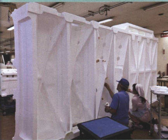
発泡スチロール模型のパーツ組立。重さは鋳鉄の400分の1と軽いので作業性が良い。
