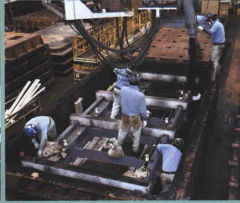
砂込作業。模型を入れた鋳枠に砂を詰める。大きいものでは1回に40tもの砂を使用する。
