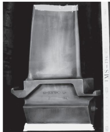
図15 第5世代TMS-196合金を用いて鑄造した発電ガスタービン用空冷単結晶動翼 (300mm長)
