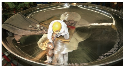
食品や薬品向けの鏡板には高い表面品質が求められ、表面研磨仕上げをおこなう場合がある。従業員の多くは溶接技能や機械保全などの資格を取得し、強い現場力で品質が維持されている。
