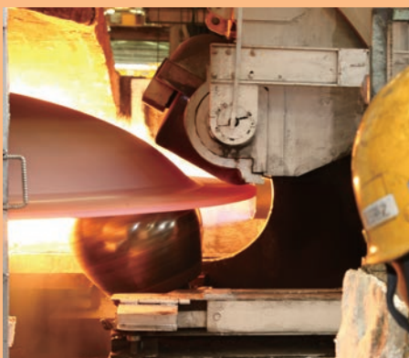
熱間スピニング加工での成形。材料を約850℃に熱し、大型ローラーで外側と内側からフランジ部を挟みこみ成形を行う。(材質:SPV355)
