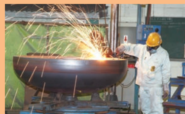
容器製造での溶接の前工程として、鏡板円周の開先形状加工を行う。
