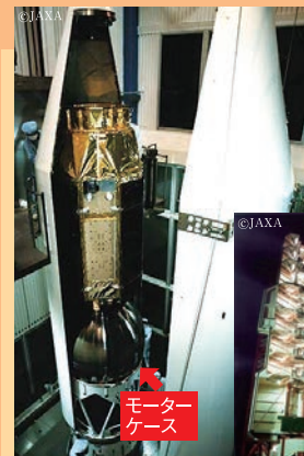
1985年打ち上げのM-3SIIロケットにはTi-6Al-4V合金製モーターケースが搭載された。この材料は大曲面の加工が難しいため、チタン合金板を炭素鋼で両側から挟んで熱間プレス加工した。これにより割れがなく、断面形状および加工後板厚について高い精度を実現した。(内径1,452mm、板厚32mm)
