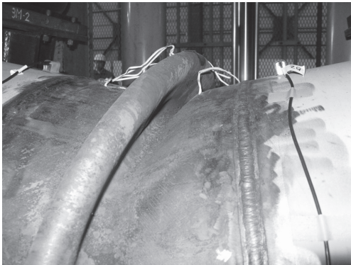
図10 φ600断層用鋼管の曲げ試験状況
