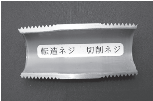
写真7 転造ねじと切削ねじの断面形状
