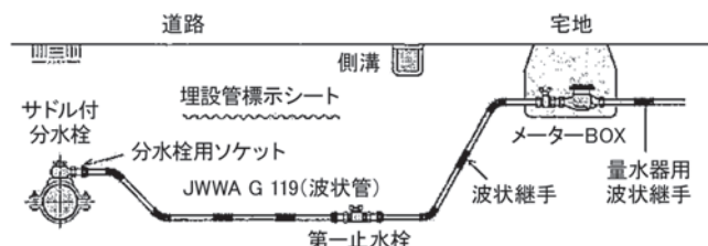
図2 ステンレス配管モデルシステム概念図 2)
