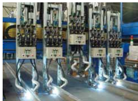
造船所のマグ溶接風景。溶接の高能率化ニーズに応え、自動化が進んでいる。
