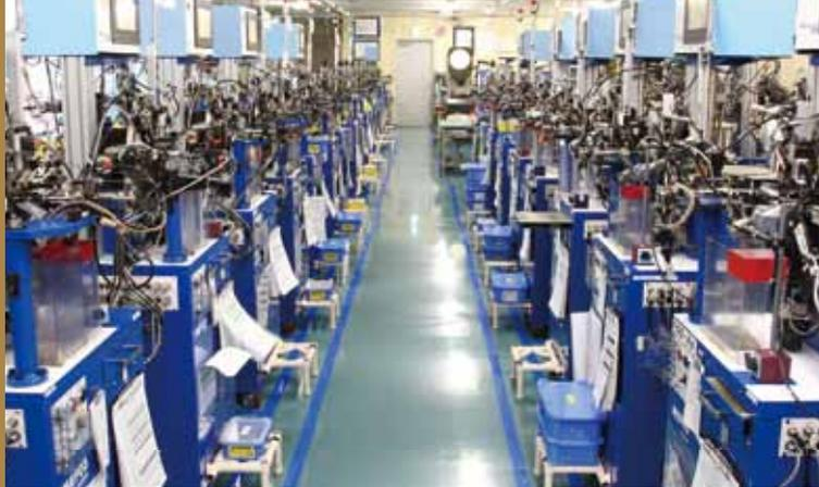
工場内は自社製NCマシンがずらりと並ぶ。加工精度はNCマシンにおいて製造と同時に自動的にチェックする。24時間無人連続加工を可能にしている。
