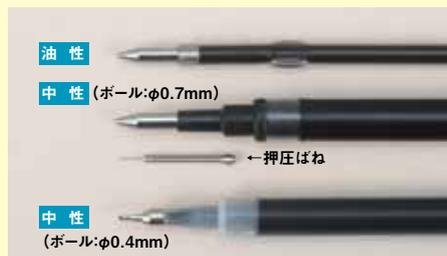
中粘度のゲルインクは溶剤分インク部分が太くなり、またインク漏れ防止のため押圧ばねがチップ先端に必要となる。
