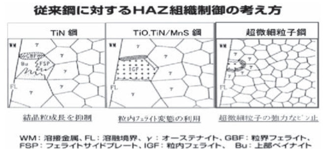
図10 HAZ靱性制御(細粒化)技術の変遷
