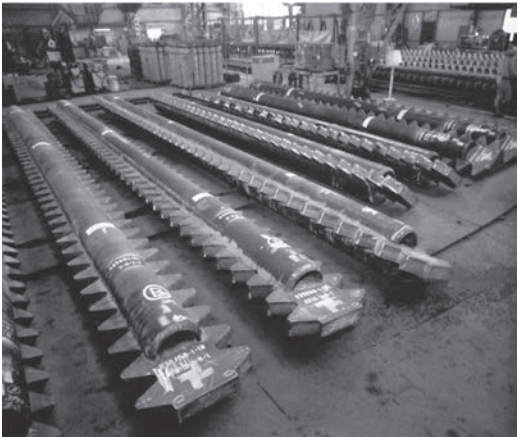
図17 ジャッキアップリグの脚部の部材
