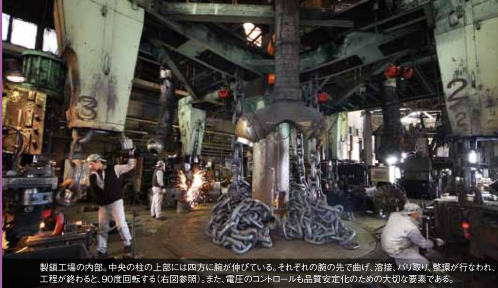
製鎖工場の内部。中央の柱の上部には四方に腕が伸びている。それぞれの腕の先で曲げ、溶接、バリ取り、整環が行なわれ、工程が終わると、90度回転する(右図参照)。また、電圧のコントロールも品質安定化のための大切な要素である。
