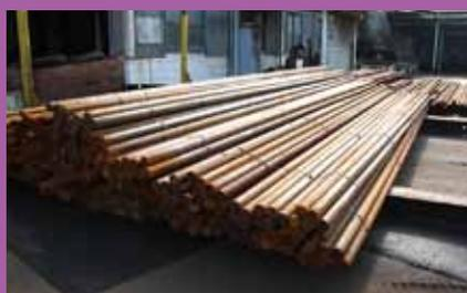
材料は高強度非調質棒鋼、鉄鋼メーカーとの開発鋼種を使用する。
