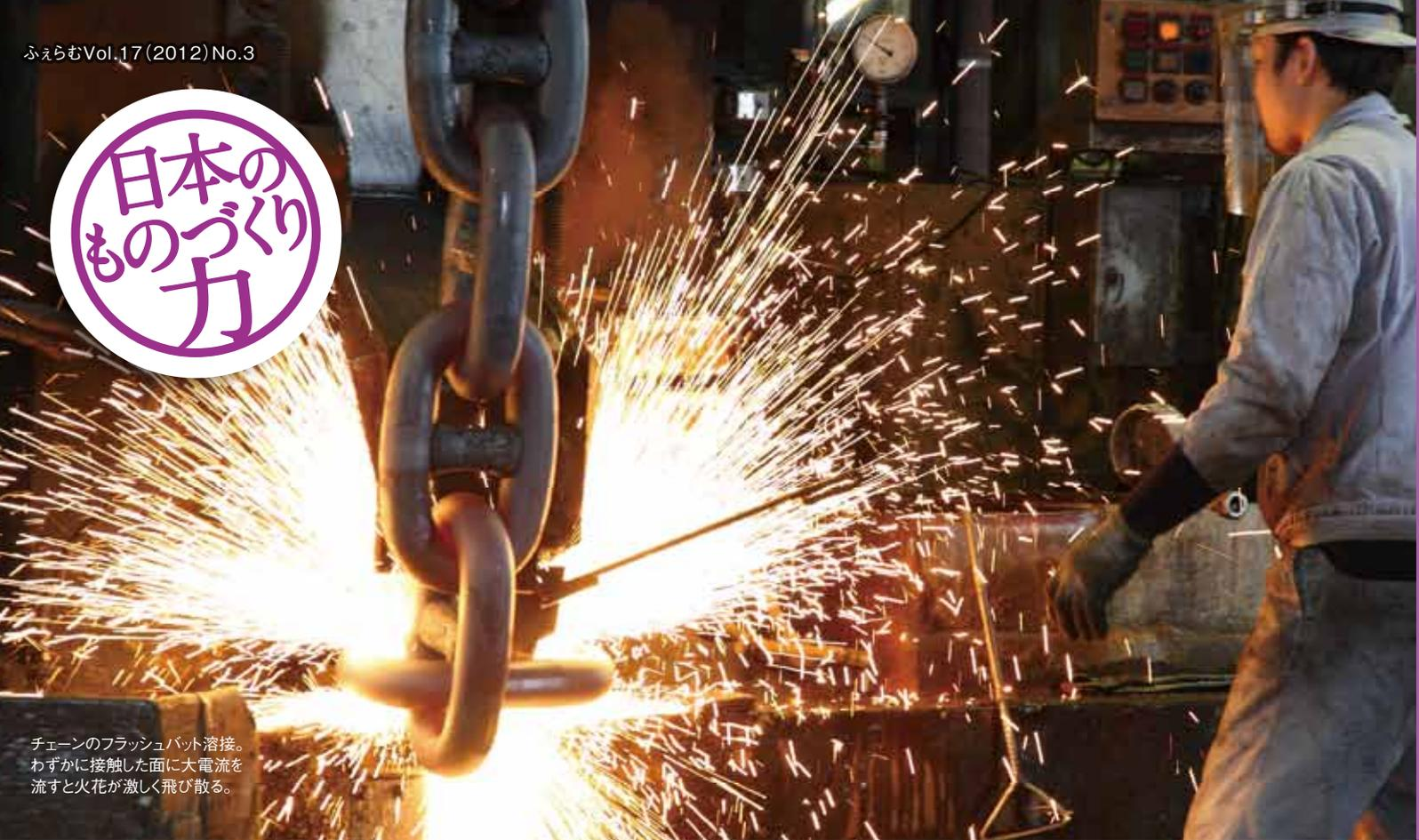
チェーンのフラッシュバット溶接。わずかに接触した面に大電流を流すと火花が激しく飛び散る。
