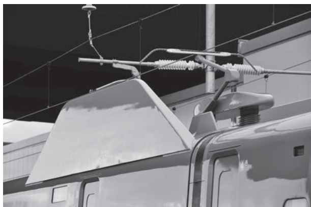
図10 低騒音パンタグラフと遮音板
