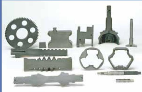
最近では硬化層の薄肉化や、他の表面処理を組み合わせた複合処理など、より高度な焼入技術の研究開発を積極的に行っている。製品の表層の色付いている部分が硬化層
