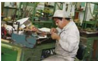
最もノウハウが詰まるコイルは、熟練技能者の手作業によって接合等が行われている。
