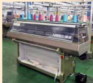
世界中で広く使用されている横編み機。編成速度は毎秒1.4mと高速であり、精密部品や高強度部品などさまざまな鉄鋼材料が使用されている。
