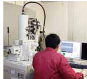
電界放出形走査電子顕微鏡 (FE-SEM) による結晶粒の解析。
