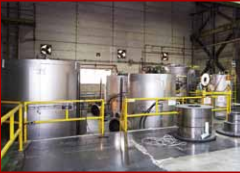
冷間圧延後は材料が硬化するため、焼なましをして再び軟化させる。焼なましは、材料をまとめて箱型炉の中に入れて行う（箱焼鈍という）。
