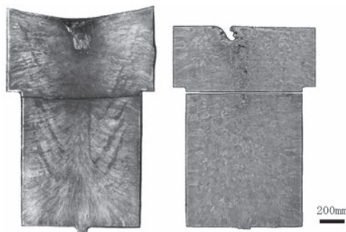
図 従来鋼(左)と開発鋼(右)の砂型鋼塊の縦断面組織
