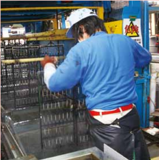
工場内は多数の技能者の手作業によって、めっきが行われる。
