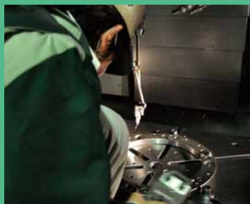
マシニングセンタの段取り。単品生産なので作業はその都度慎重に行われる。
