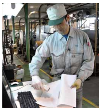
製品図面と個々の部品はバーコードで工程管理されている。
