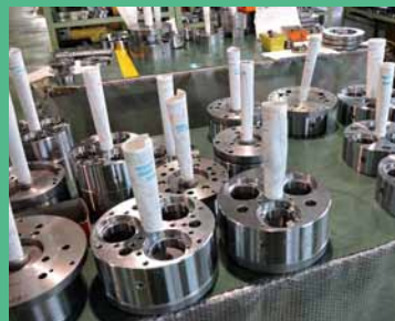
チャックごとに部品が異なるため、部品はつねに図面とともに工程間を移動する。
