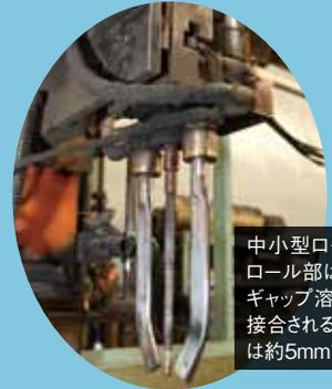
中小型ロールの軸部とロール部は、自動ナローギャップ溶接機によって接合される。トーチの厚さは約5mmである。
