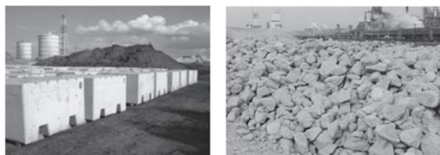
写真3 鉄鋼スラグ水和固化体製品の外観
