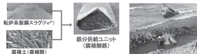
写真4 鉄分供給ユニットの構成例
