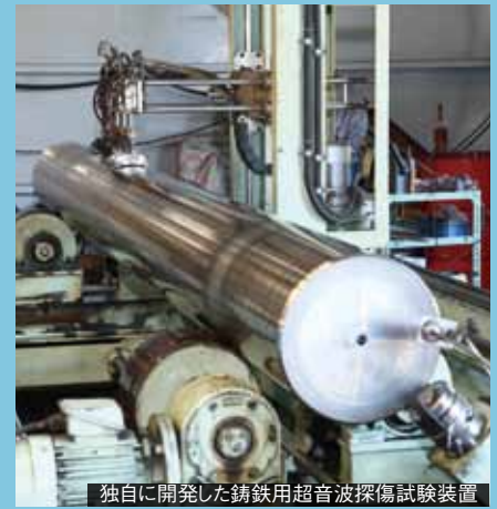
独自に開発した鑄鉄用超音波探傷試験装置
