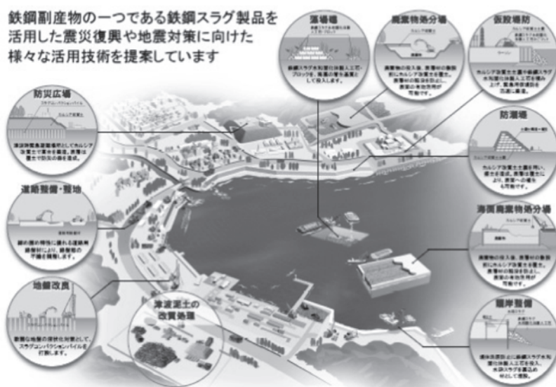
図13 震災復旧への鉄鋼スラグ製品の提案例 60)
