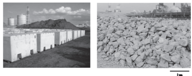
写真3 鉄鋼スラグ水和固化体製品の外観
