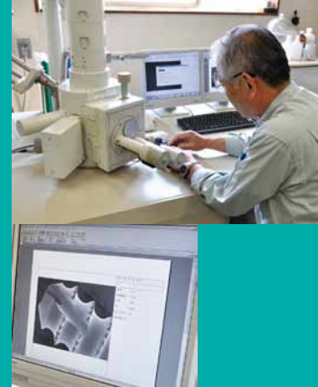
微細ねじの表面性状をSEMによって観察する。(下)チタン製ねじのSEM画像
