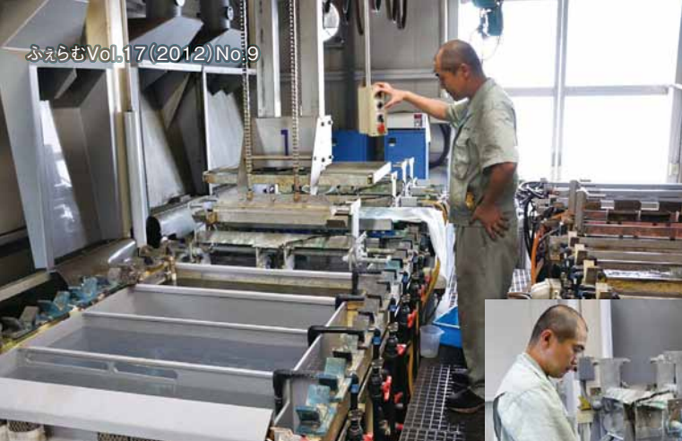
ニッケルバレルラインでは、部品をバレルの中に入れてめっきを行う。通常はすべて自動運転されている。(右)部品をバレルの中に投入しているところ。
