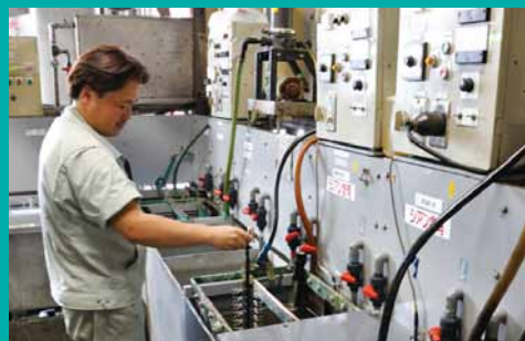
ニッケルバレルラインでは、部品をバレルの中に入れてめっきを行う。通常はすべて自動運転されている。(右)部品をバレルの中に投入しているところ。
