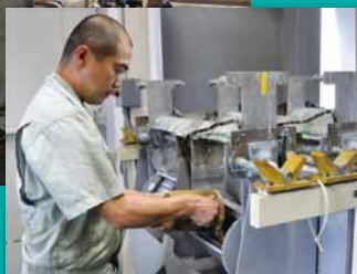
ニッケルバレルラインでは、部品をバレルの中に入れてめっきを行う。通常はすべて自動運転されている。(右)部品をバレルの中に投入しているところ。
