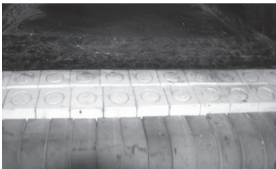
図5 インペラ前縁部セラミックス設置例
