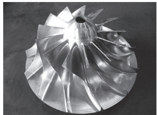
図14 インペラ例 (高比速度タイプ) 比速度 N_s 400
