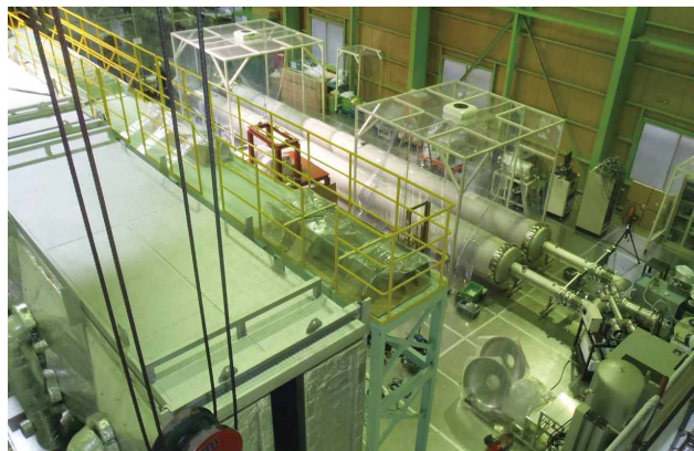
ベーキング炉(手前)とリーク検査中のダクト(奥) 写真提供：(株)ミラプロ、野田工場
