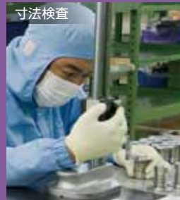
品質検査では、寸法検査やリーク検査、外観検査などの全数検査を実施している。
