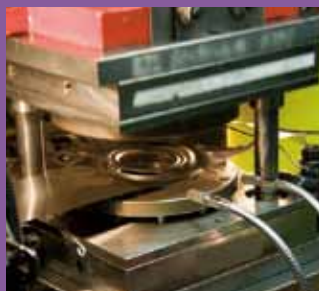
部品となる中空円盤は、薄板からプレス 打ち抜きにより成形される。
