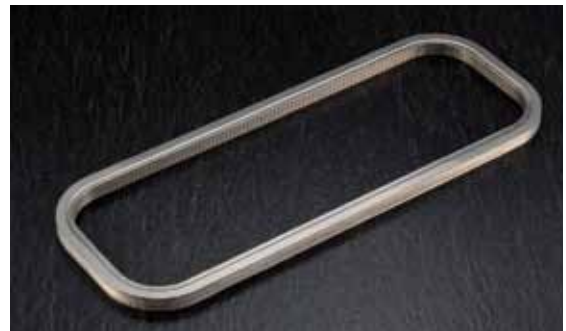
真空装置同士の連結に使用する角型ベローズ。従来は手動溶接が多かったが、一体プレス成形の大型部品を自動溶接によりベローズ形状に製造する技術が開発された。溶接は、パーティクルの混入を避けるため、高グレードのクリーンルーム内で行われる。
