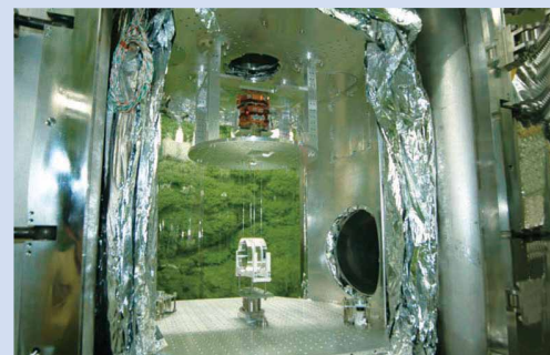
レーザー干渉計ではサファイア製の反射鏡が用いられる。写真(右):日本の重力波検出器(CLIO)で使用されている直径10cm、厚さ6cmの反射鏡。写真(上):反射鏡の上に見えるのが懸架システム。
