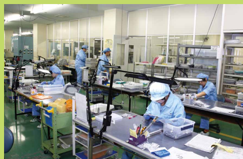
小型ベアリングでは機器からの騒音が問題となることが多く、 出荷前の音響検査がきわめて重要である。
