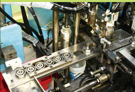
自動組立装置で、各パーツを自動でセットする 工程。この後、グリスを封入しシールする。
