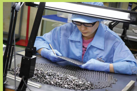
ベアリング表面に光をあて、ベテランの検査員により目視検査 を行う。このような検査こそ品質を守る生命線となる。
