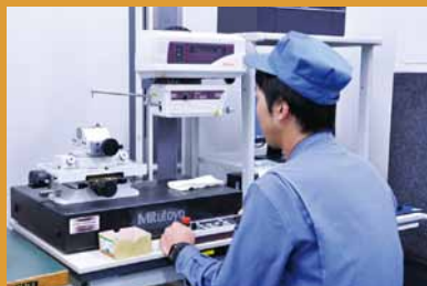
加工精度検査。研削盤による精密加工の精度を保証するため、測定機器での試験などを徹底して行う。
