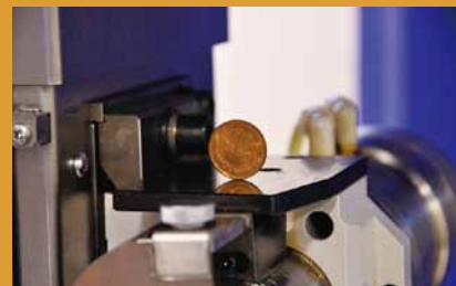
独自ハイレシプロ機構を採用し、高速でありながら砥石軸ユニットの振動を限りなく抑える。装置上に立てた10円硬貨は、動作中でも振動で倒れることがない。
