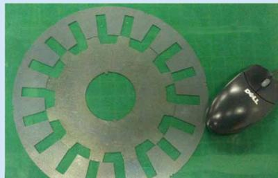
SRMのケイ素鋼板。規定の形状に打ち抜いたケイ素鋼板を積み重ねて、積層鉄心とする。
