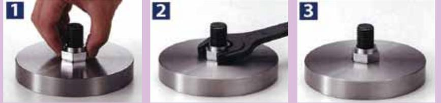
取付部材にボルトを通し凸ナットをセットして下さい。
