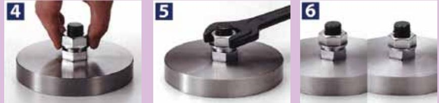
次に凹ナットを手でセットして下さい。この時に凹凸ナットに隙間が1ピッチ程度あることを確認して下さい。
