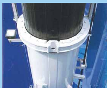
高張力鋼板を採用し、断面形状を工夫したブームの採用により、車両の軽量化とクレーン性能の両立を実現した。
