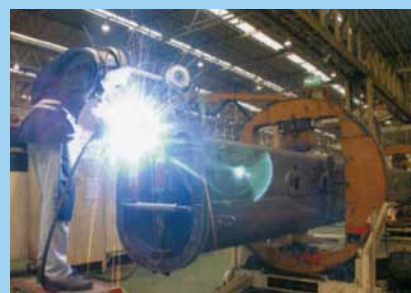
ブームの高張力鋼板の溶接工程。溶接性の改善により、信頼性の高いブーム構造を可能としている。
