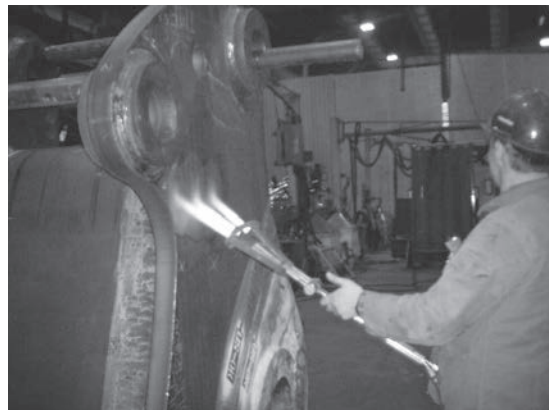
図10 溶接構造物の予熱作業
