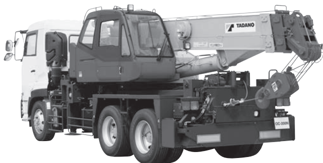
図3 トラッククレーン
